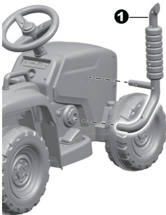
Krok 1: nasadenie výfukovej rúry.
